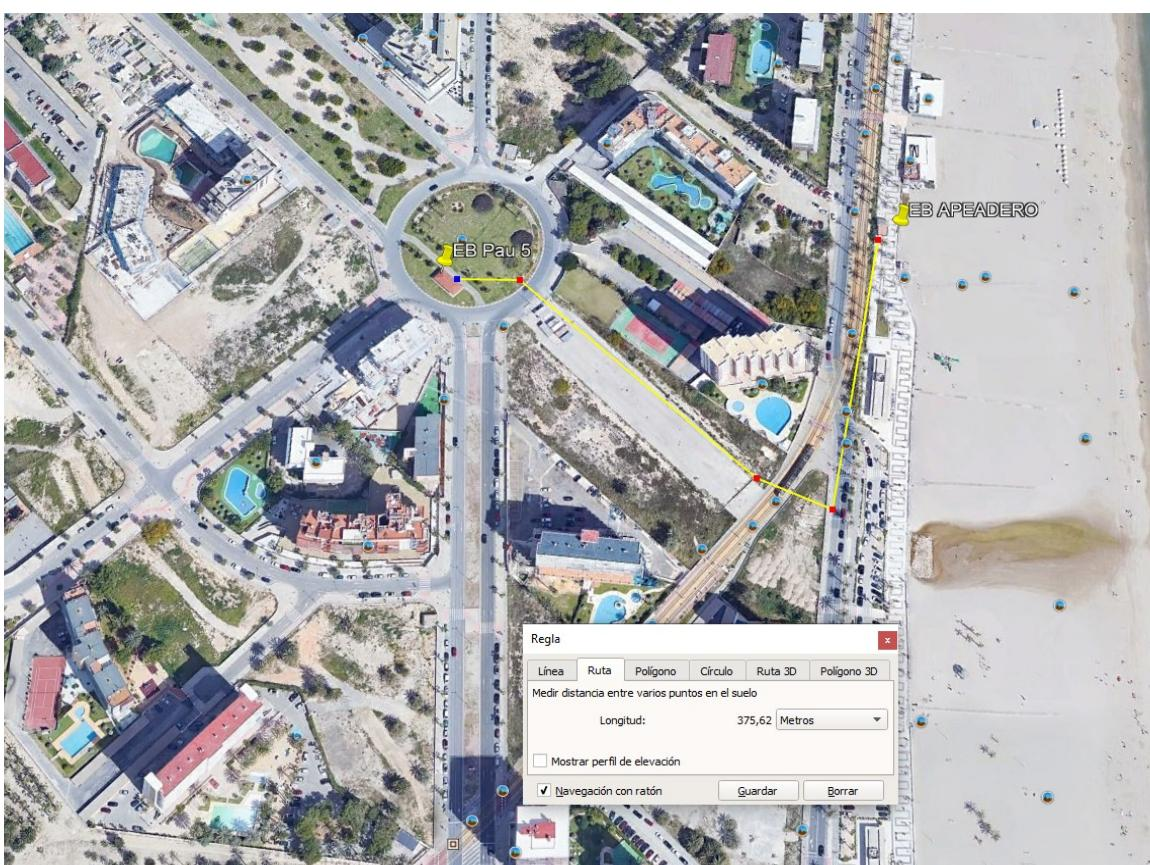
Longitud 375 m Ø 250 mm Fundición Dúctil
